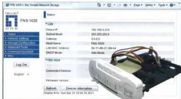
FNS-1020 obsługuje twarde dyski obu rodzajów, PATA i SATA.
